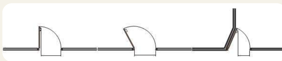
Рисунок 3.6. Схеми вимірювання просвіту дверей у квартирі
