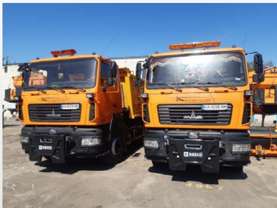
Спеціалізований вантажний самоскид МАЗ 6501 С5- 524-000 із обладнанням RASCO для зимового утримання – 2 шт.
