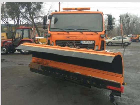
Машина комбінована дорожня МКД- 11-04.08 на шасі МАЗ-5340С2-525-013
